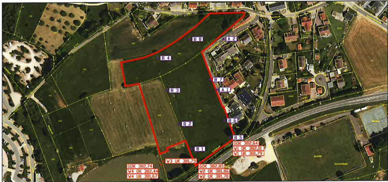
Abb. 4: Luftbild [U 2] mit Markierung der Aufschlusspunkte (lila Kreise - RKS, rote Quadrate - Wasserprobenahme); unmaßstäblich, genordet.
